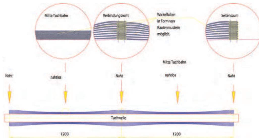
**Bild 9.1.11 Unterschiedlicher Wickeldurchmesser im Naht- und Saumbereich**
